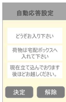
自動応答設定を行うと、設定後2時間はインターホンからの呼出通知が来ずに、マンションのインターホンが自動的に設定したメッセージで代理応答します。
