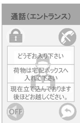
着信確認画面又は通話画面で「代理応答」ボタンをタップすると、代理応答メッセージの選択ダイアログが表示され、メッセージを選択すると、マンションのインターホンが自動的に設定したメッセージで応答します。
